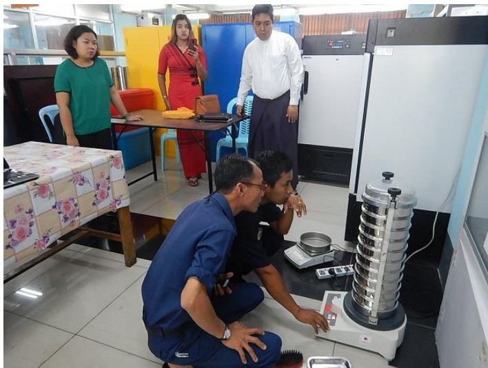
ろ過砂及びアンスラサイトの粒径確認
