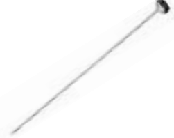
写 1 メーター・公道の栓・弁を接点として漏水の有無を調べる。
