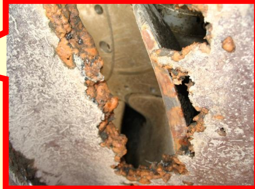
事例1 キャビテーションによる壊食(ポンプケーシングに穴)
