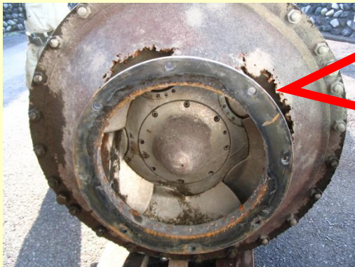
事例1 キャビテーションによる壊食(ポンプケーシングに穴)
