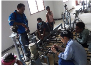
図6 薬品注入ポンプのメンテナンスの指導
