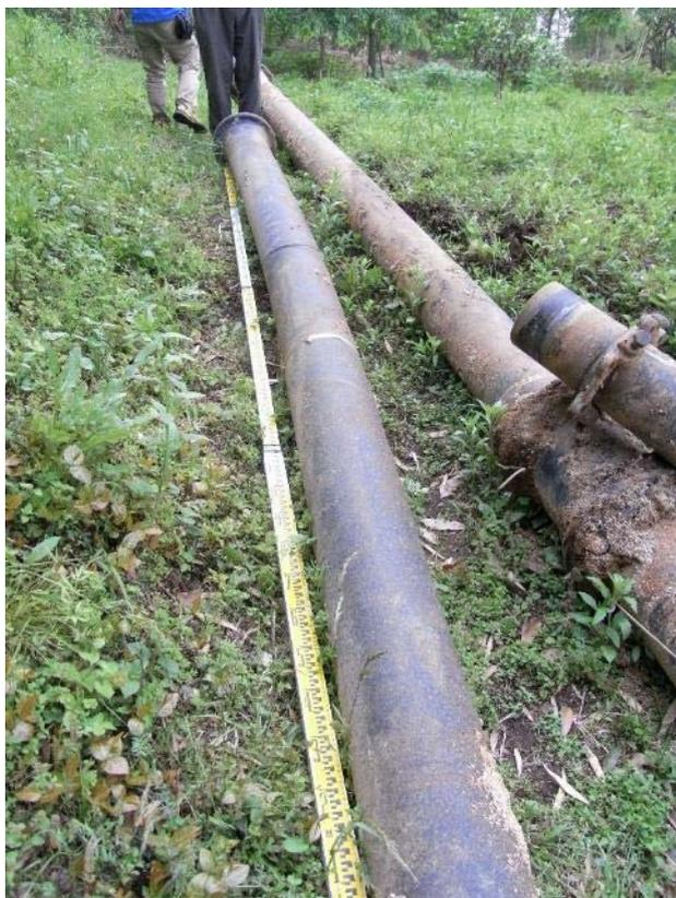
口径200mmと150mmK形ダクタイル鉄管の被害の様相(益城町福田地区)。管体の歪みが、激しい力が加わったことを物語っている
